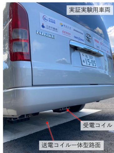
実証実験で使用する車両と路面構造
